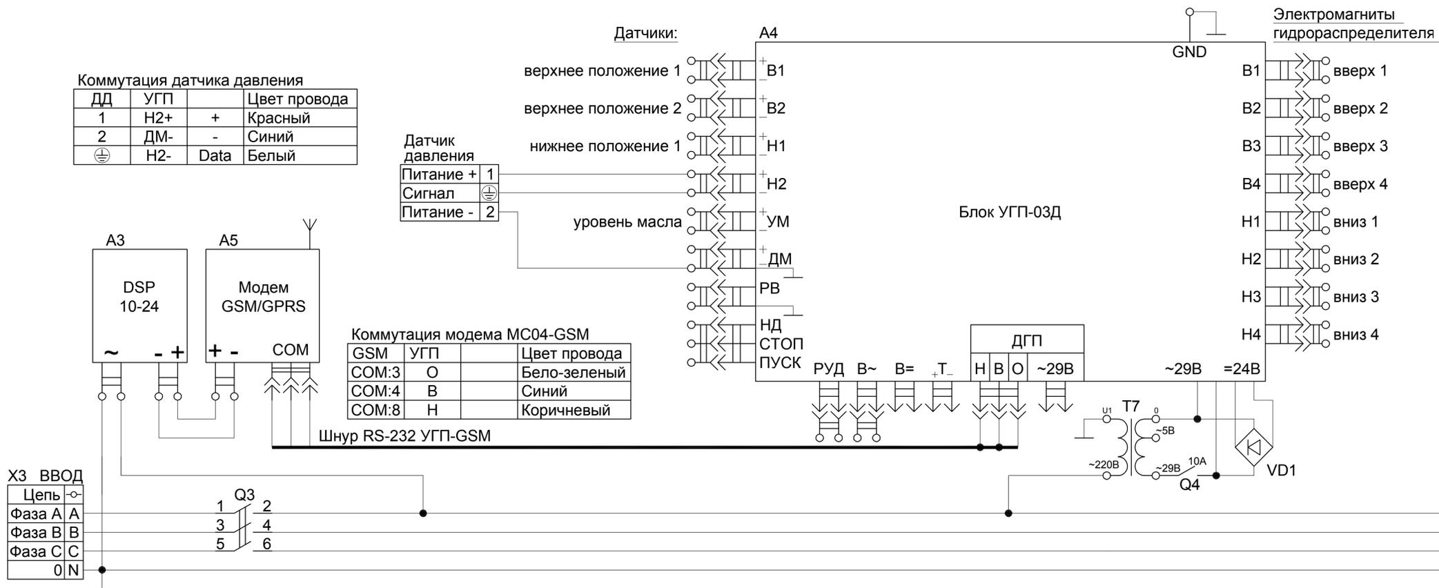
Схема подключения датчика давления и модема MC04-GSM/GPRS для блоков УГП-03Д (блок УГП-03 с функциями динамографа и мониторинга).
